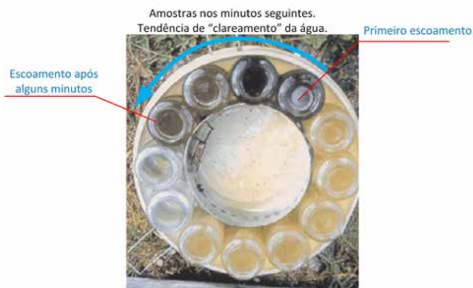
Figura 29. Amostradores de qualidade da água pluvial Fonte: adaptado de Tucci (2006)
