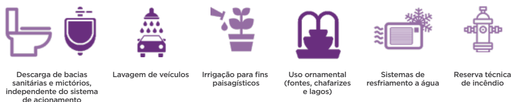
Figura 26: Usos não potáveis contemplados pela norma ABNT NBR 15527
