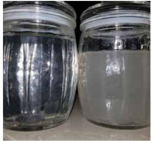
Foto 2.2. Amostras de efluente bruto (à direita) e tratado (à esquerda)
