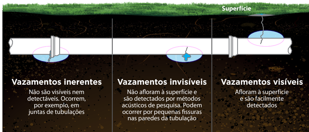
Figura 3. Tipos de vazamentos em tubulações
